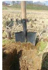
<삽을 이용한 시료채취>
