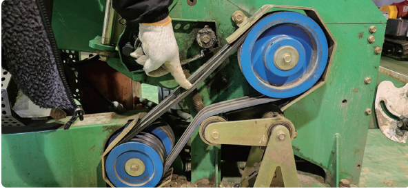
엔진 정지 후 파쇄레버 연결하여 벨트 장력 확인 *장력 1cm 내외
