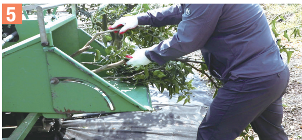
5 파쇄목 중간 이하 뒷 부분을 잡고 투입 ★투입구에 무리하게 손을 깊숙이 넣는 행위 절대 금지
