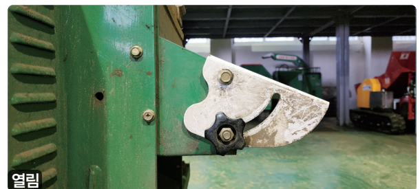
배출구 조절부가 '닫힘' 상태인 경우 파쇄 막힘 증상 발생 ▶ 조절부 '열림' 상태에서 작업
