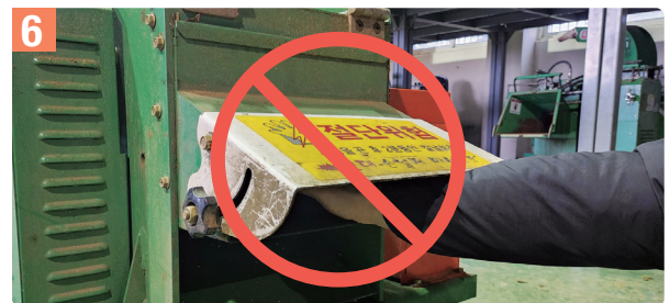
6 배출구에 손 넣는 행위 절대 금지 ※작업 완료, 엔진 정지 후에도 2~3분동안 칼날 회전함
