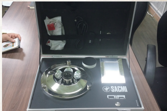
경도, 당도, 색도, 건물중 동시 측정 가능한 기기
