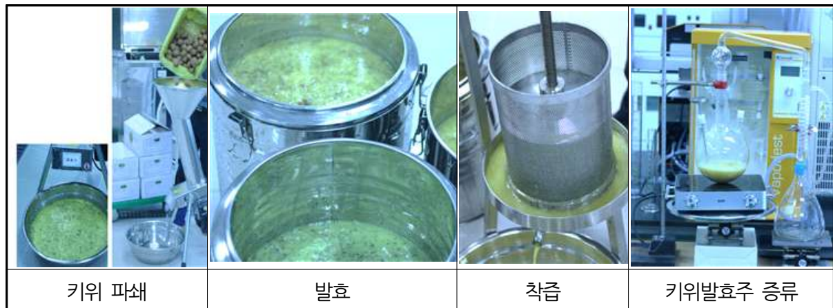
그림 28. 키위 증류주 제조 순서 및 방법
