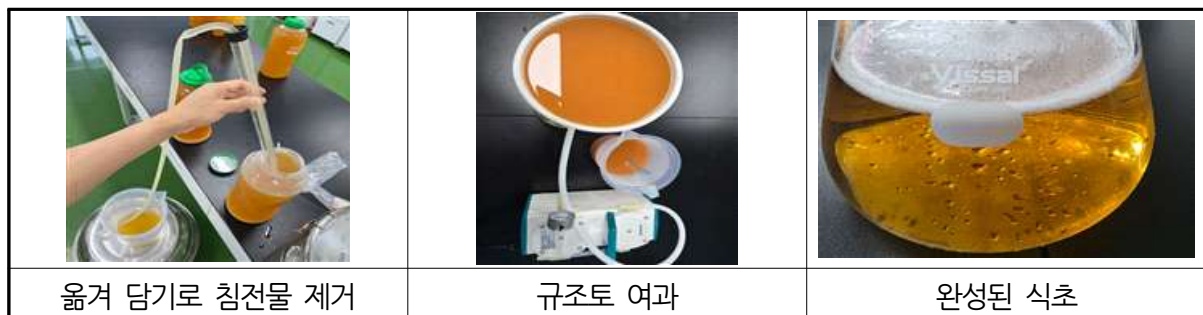
그림 33. 발효가 끝난 식초의 규조토 여과 과정
