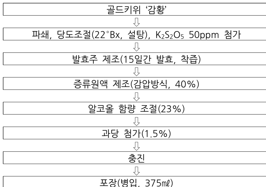
그림 29. 골드키위 감황을 활용한 저도주 과일증류주 제조 공정도(좌)와 시제품(우)
