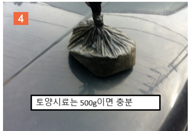
시료봉투는 지퍼팩, 그린팩 또는 깨끗한 비닐 봉지 사용 ※농약봉지, 비료포대, 영양제봉지 등은 토양분석에 영향을 미칠수 있으므로 주의
